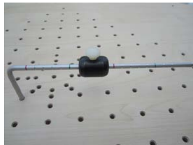
Aluwinkel mit Gewicht und Skalierung
