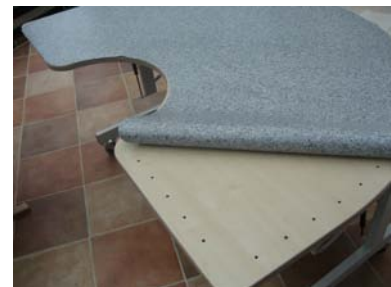
PVC-Belag zugeschnitten auf Plattengröße mit drei Fixierbohrungen
